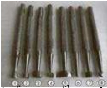
ภาพที่ 2.55 เครื่องมือตอกลาย 1.เหล็กตอกลายเปลือกหอย 2.เหล็กแรงเงา 3.เหล็กตอกลายนูน
